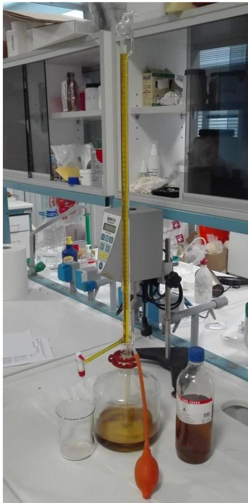
**Figura 1.** Set up della prova di assorbimento di olio.
